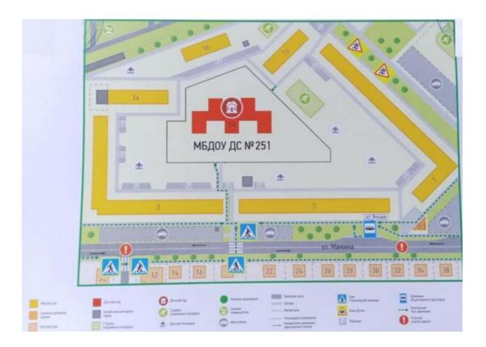
План-схема организации дорожного движения в непосредственной близости от образовательного учреждения с размещением соответствующих технических средств, маршруты движения детей и расположение парковочных мест.
